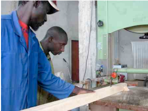
Ousmane und Omar bearbeiten die Rostlatten an der provisorisch eingerichteten Bandsäge
